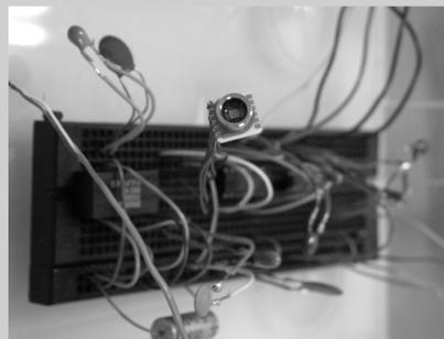
Fig.3 – Imagem do sensor de pressão em primeiro plano e logo à esquerda a base de tempo de 32 kHz (CI). Ao fundo é possível observar os outros 2 CI's para a interface com a porta paralela.
