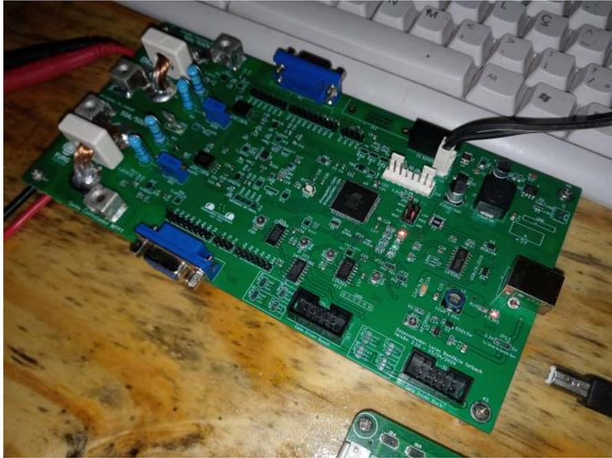
Figura 4.23: Montagem final da PCB. Fonte: o autor
