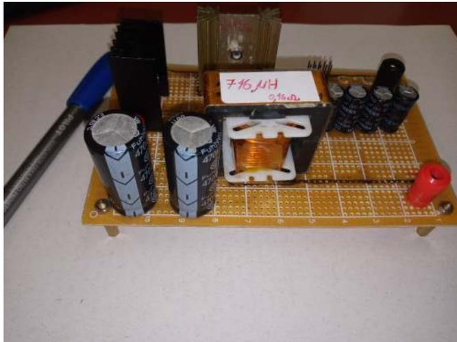
Figura 4.33: Montagem do conversor *boost*. Fonte: próprio autor.
