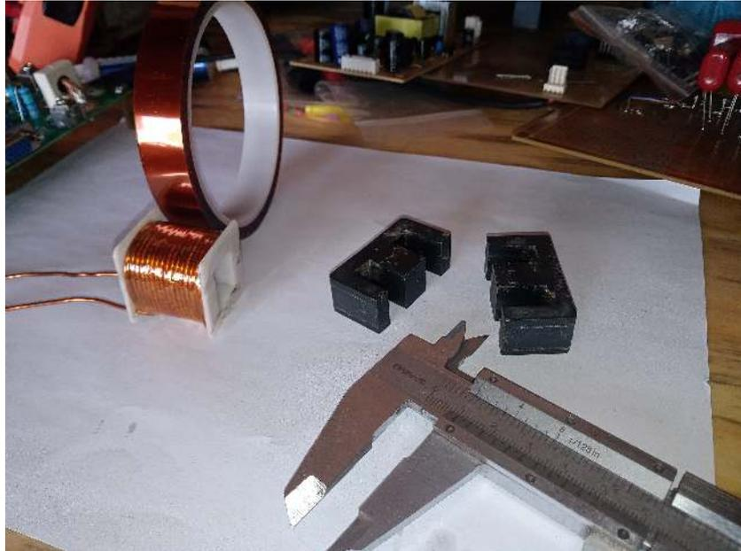
Figura 4.29: Construção do indutor. Fonte: próprio autor.
