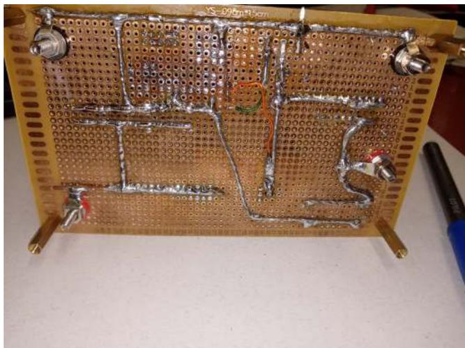
Figura 4.34: Vista inferior da placa do conversor *boost*. Fonte: próprio autor.
