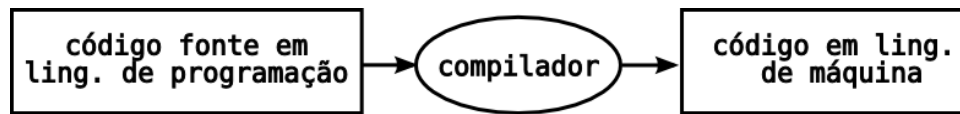
Figura 2.3: Compilação: o programa em linguagem de programação é transformado em instruções em linguagem de máquina (que o processador pode executar).
