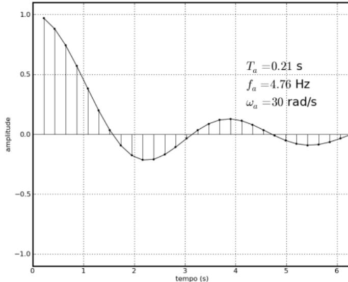
Frequência linear e angular de amostragem
